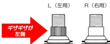
③ペダルの取り付けは、はじめに手で締められるところまで締めた後、スパナ/専用工具等でしっかりと本締めして、がたつき等ないか確認して下さい。
