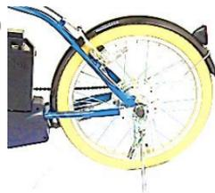
③フレーム締付レバーを上を上げフレームジョイント部をはめ込みロックする。
