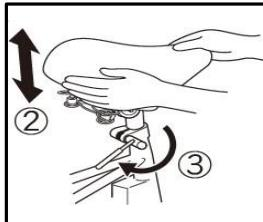
サドルの高さを調整して固定レバーを右回しにまわして固定します。
