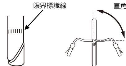
緩衝材やハンドルポスト先端のキャップを外します。キャップはハンドル上部のねじを緩めて取り外してください。
