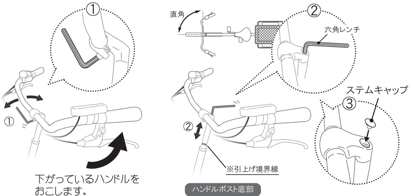
ハンドルポストを引き抜くと図のように部品が取り付けられています。
