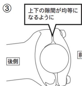
⑤ 上下の隙間が均等になるように注意して締め付けてください。
