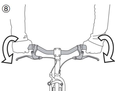
※ハンドルにガタがある場合は、クランプボルトをゆるめた状態にしてから、上部アンカーボルトを締め込んで調整してください。
