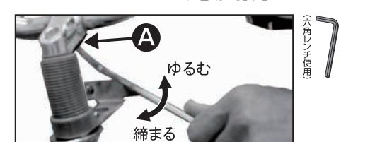
ハンドル中央下部のネジ(A)を左に回して緩め、バーを適当な角度に動かして合わせます。
