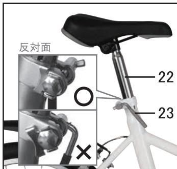
サドル固定レバー(23)を反時計回りに回すと、シートポスト(22)が緩みます。固定する場合は、時計回りに締めつけます。
