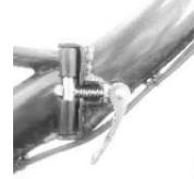
レバーを引き上げながら前後のフレームを密着させます。正しくセットされるとレバーが下にさがりロックされます。
